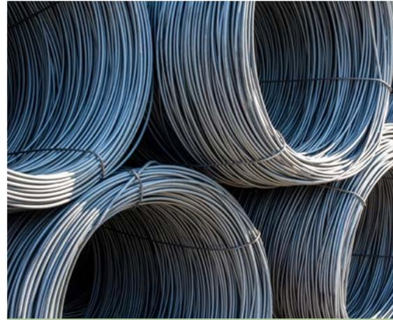
عبارة عن حديد مدلفن من سبائك أو فولاذ خام يتم إنتاجه من أشكال شبه جاهزة (مثل الكتل الخام) ويأتي بمقاطع عرضية دائرية ومستطيلة وغيرها. ويمكن الحصول على مقاطع عرضية دقيقة بشكل خاص عن طريق التشكيل على البارد. يتم لف قضبان الأسلاك في لفائف ونقلها في هذا الشكل، ويستخدم للقطع والنثي وشبكة الأسلاك، وبشكل خاص في المنتجات مسبقة الصنع التي يتم قطعها في مواقع أخرى، بالإضافة إلى استخدامات أخرى متعددة.
