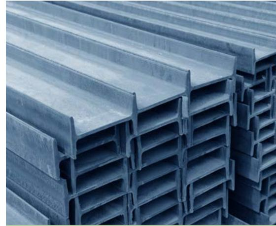
هو منتج من الحديد يستخدم بشكل رئيسي في مواد البناء. تأتي هذه المقاطع الفولاذية بأشكال مختلفة، حيث تأخذ شكل عارضة ممدودة ذات مقطع عرضي محدد، مثل العوارض I، والعوارض H، والزوايا، والقنوات، وغيرها، وبشكل عام، تصنف المقاطع الفولاذية إلى خفيفة ومتوسطة وثقيلة. وتختلف أشكالها وأحجامها وتركيبها الكيميائي وخصائصها الميكانيكية مثل القوة والمتانة. وتستخدم لإنشاء المستودعات والمباني التجارية وغيرها من المنشآت.
